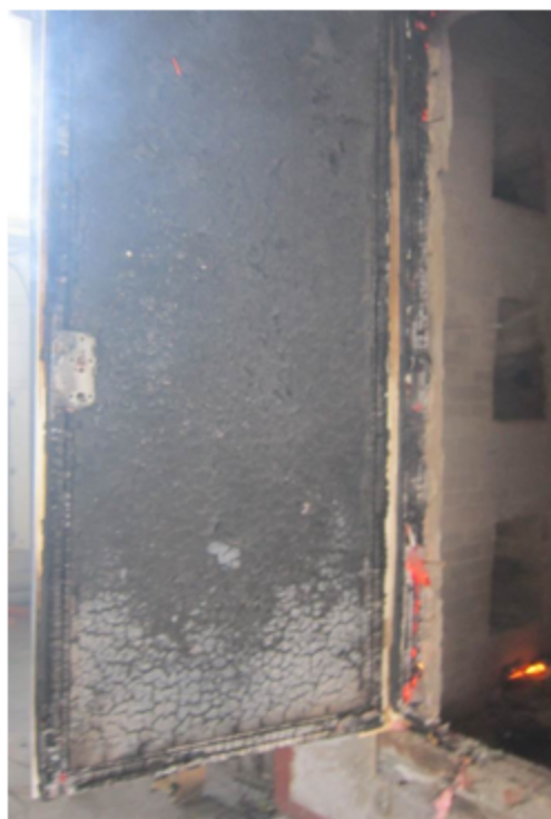
Рис 3. Зразок після випробувань з вогневої сторони
